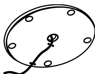
Étape 5 : Fixer le chauffe terrasse au sol. Percez trois trous dans le sol et fixer le chauffe terrasse au sol à l'aide de trois boulons de calage.
