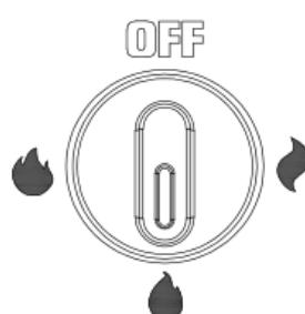
3. Zet de schakelaar op " 🔥 ", dit betekent dat het verwarmingselement werkt en op de maximale verwarmingsstand staat (2100W).
