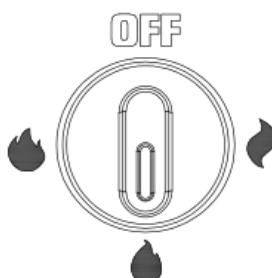
3. Tournez l'interrupteur sur " 🔥 ", ce qui signifie que l'élément chauffant fonctionne et qu'il est réglé sur la température maximale (2100 W).
