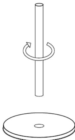
Étape 2 : Relier le tube central au tube inférieur en les vissant l'un à l'autre.
