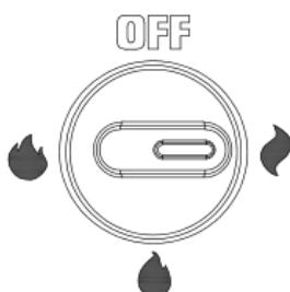
2. Positionnez l'interrupteur sur " 🔥 ", ce qui signifie que l'élément chauffant fonctionne et qu'il est réglé sur une température moyenne-élevée (1200W).
