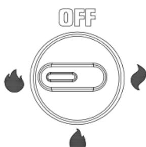
4. Tourner l'interrupteur sur "OFF", le chauffage est éteint
