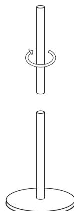
Étape 3 : Insérez la fiche du cordon d'alimentation dans le tube central, le tube inférieur et la base et connectez la tête chauffante en les vissant ensemble.
